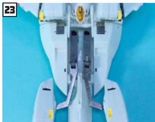
次に脚部を機体に装着します。写真の黄□部分がジョイント(機体部が凸、脚部が凹)です。
