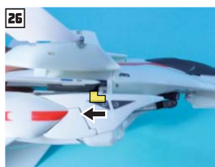
差し込んだら、機体側の凸がフック状になっていますので、脚部を機体後方に向けてスライドさせて固定します(左右)。
